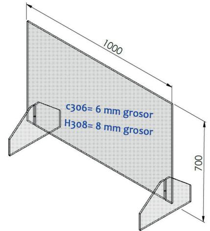
Mamparas de protección de policarbonato transparente. Fácil manejo y extra resistente con un grosor a escoger de 6 o 8 mm.
